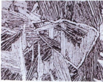
图1 \phi 260mm锻棒高倍照片 (轴向) Fig. 1 Image of \phi 260mm forged bar (axial)
